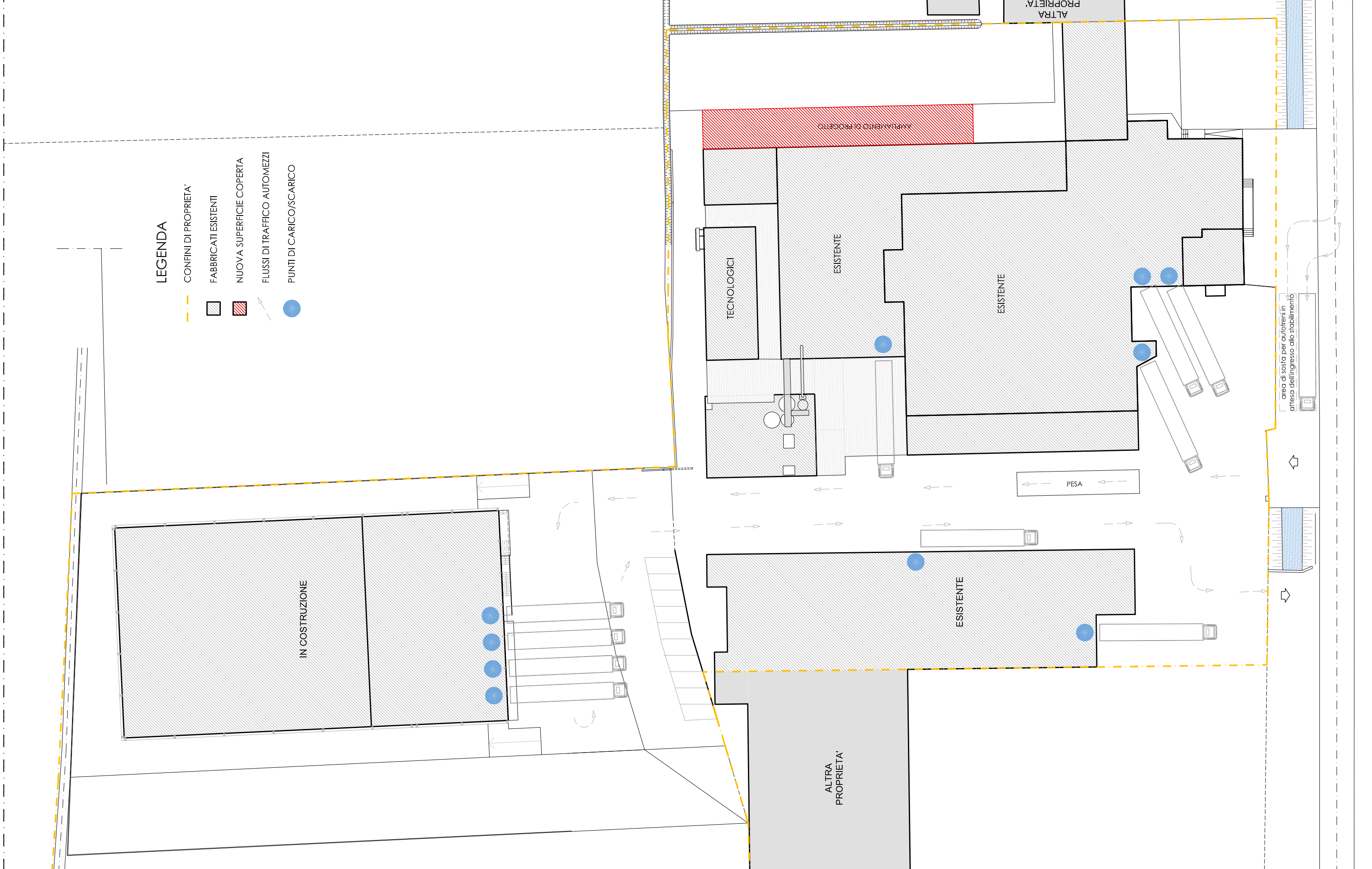
SCHEMA VIABILITA' INTERNA E ACCESSI CARRAI, SCALA 1:500
